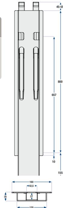
4 Poteau arrière à **simple verrouillage**
