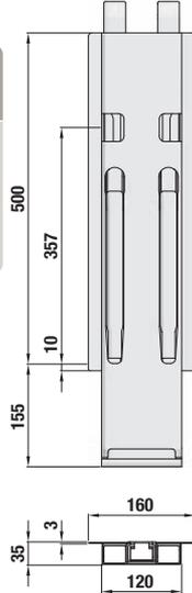
4 Poteau arrière à **simple verrouillage**
